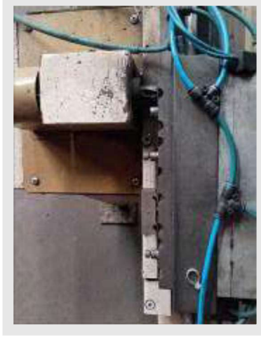
FRESADORA HORIZONTAL PNEUMÁTICA PARA ACABAMENTO EM EIXO (FABRICAÇÃO PRÓPRIA) | Item: 340 |
