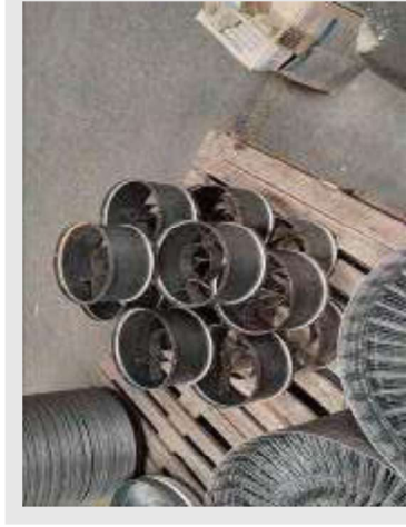
CAIXA EXTERNA EM AÇO CARBONO PARA EXAUSTOR SEM PINTURA (7 DIAM 0.50) (18 DIAM 40) (15 DIAM 0.30) | Item: 619 |
