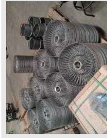
GRADE EM AÇO CARBONO PARA VENTILADOR FALTANDO PINTURA (900 PÇS) | Item: 618 |
