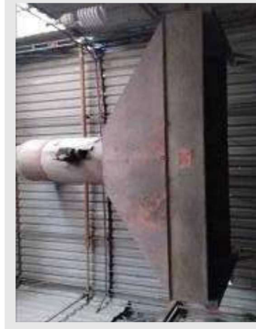
COIFA EM AÇO CARBONO COM EXAUSTOR DIAM 1.0 M MOTOR DE 3CV DIM 4.50X1.90X2.00 M COM LAVADOR DE GASES | Item: 348 |
