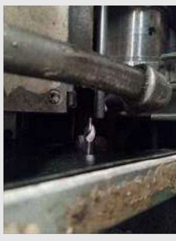
MÁQUINA PNEUMÁTICA PARA DAR ACABAMENTO EM EIXO (FABRICAÇÃO PRÓPRIA) | Item: 338 |
